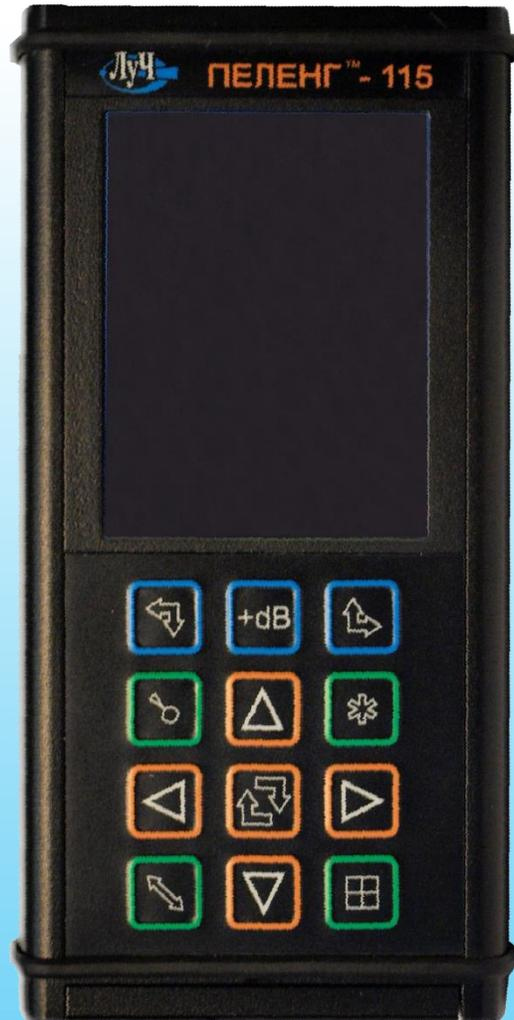
Предназначен для контроля продукции на наличие дефектов типа нарушения сплошности и однородности материалов готовых изделий, полуфабрикатов и сварных (паяных) соединений, а также для измерения глубины и координат залегания дефектов. Прибор может быть использован во всех отраслях промышленности.
