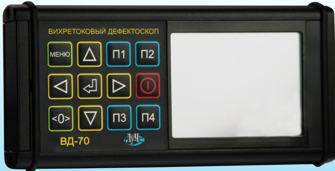
Предназначен для контроля продукции из ферромагнитных и немагнитных металлов и сплавов на наличие поверхностных дефектов типа трещин, определения местоположения дефектов и оценки их глубины.
