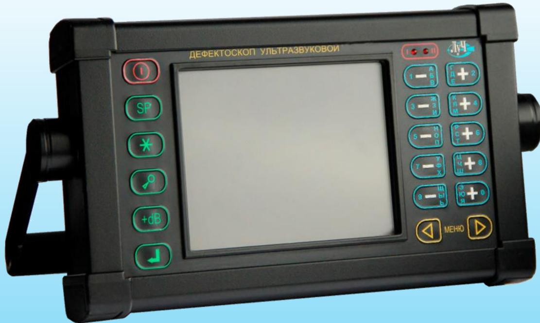
Предназначен для контроля продукции на наличие дефектов типа нарушения сплошности и однородности материалов, полуфабрикатов, готовых изделий и сварных соединений, для измерения глубины и координат их залегания, измерения отношений амплитуд сигналов от дефектов.
