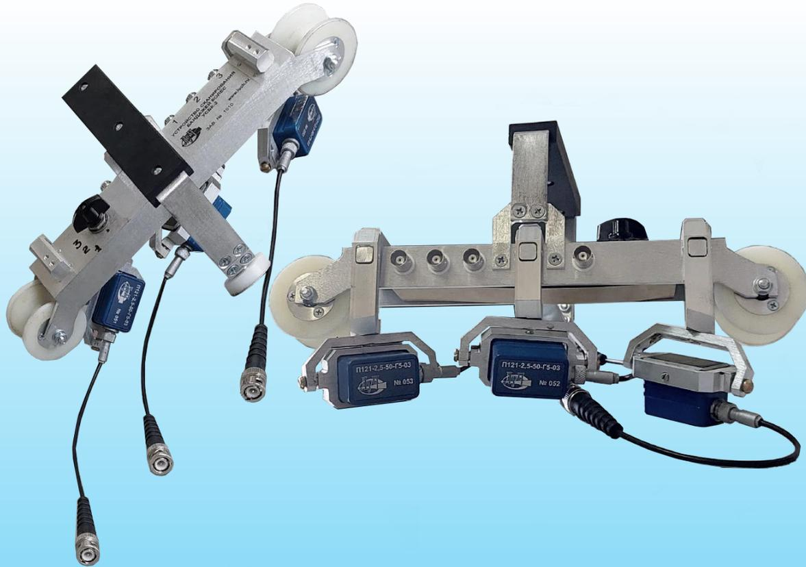
Является составной частью системы УЗК, предназначенной для комплексного ультразвукового контроля бандажей и ободьев колес диаметром 950-1250 мм, а также вагонов электропоездов, колес грузовых и пассажирских вагонов после выкатки колесных пар и установки их на стенд для осмотра и освидетельствования.
