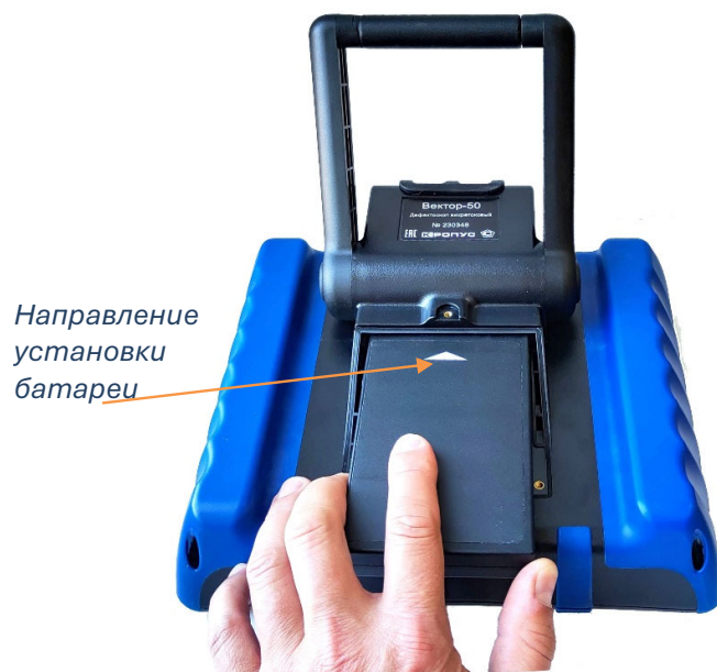
Рис 1-4 Установка нового аккумулятора
