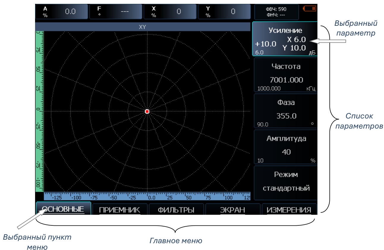
Рис 1-7 Главное меню дефектоскопа
