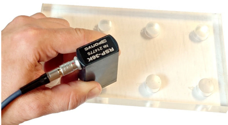
Рис.Б-9 Измерение глубины искусственных дефектов на образце СО-91
