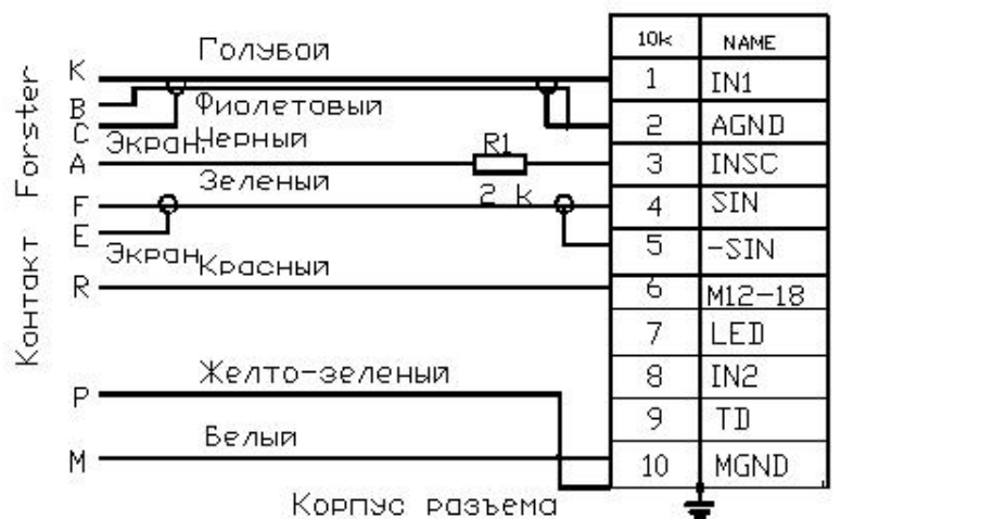
б) подключение ротационного датчика Forster
