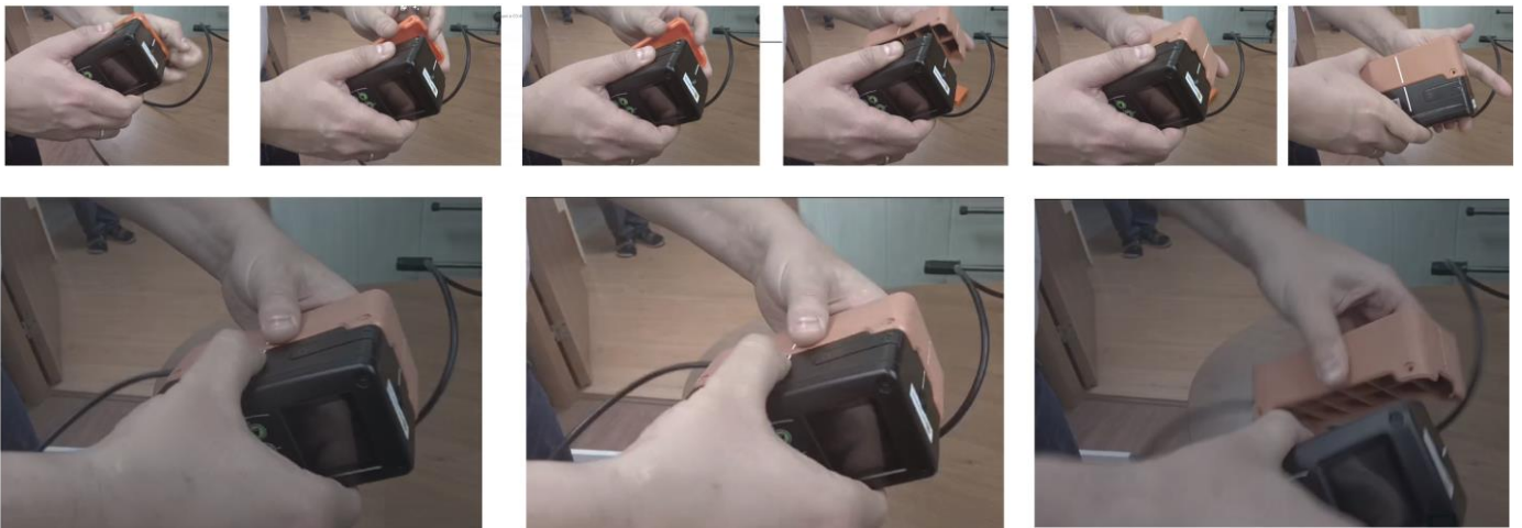
Рисунок 42. Замена резинового и пластикового протекторов.
