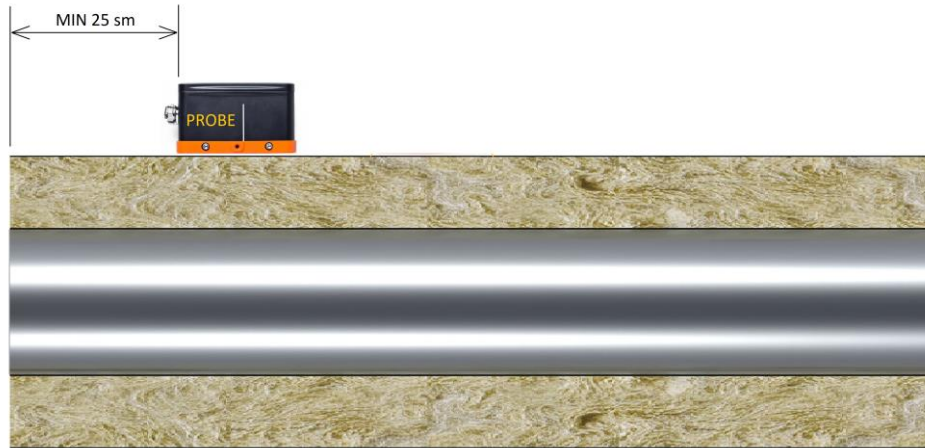
Рисунок 46. Датчик располагать не ближе, чем 25 см от торца трубы.
