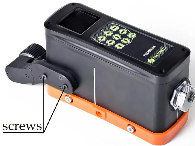
Рисунок 61. Расположение энкодера на датчике.
