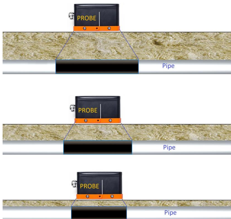
Рисунок 45. Зависимость размера области намагничивания от толщины изоляции.
